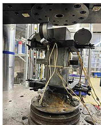
Рис. 2. Призмы 100х100х400 из легкого высокопрочного бетона с встроенными термопарами ТПК 011–05/1
