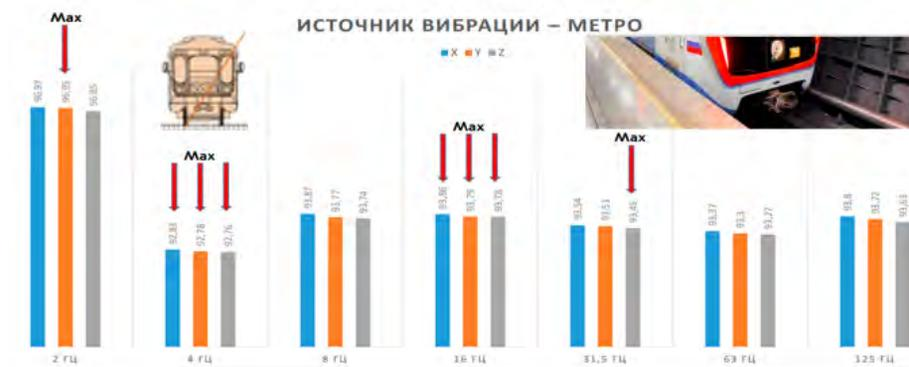
Рис. 6. Графическое отображение уровней виброускорений по улице Краснопрудная от источника вибрации — метро. Источник: автор исследования
