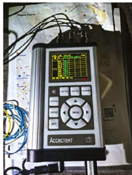
Замеры в нише обделки метро с помощью анализатора шума и вибрации «Ассистент»
