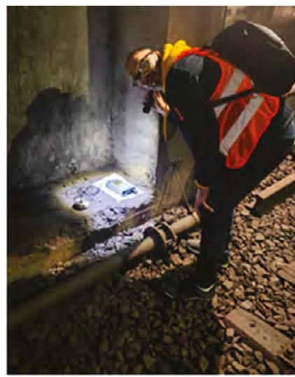
Рис. 3. Фотофиксация проведения замеров вибрации в метро. Источник: автор исследования
