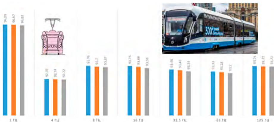
Рис. 7. Графическое отображение уровней виброускорений по улице Краснопрудная от источника вибрации — трамвай. Источник: автор исследования
