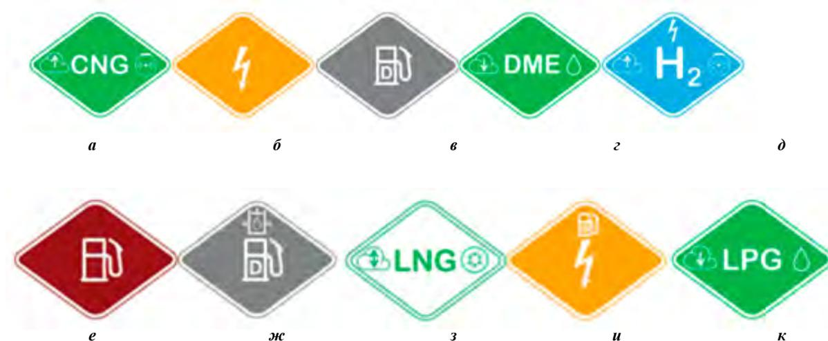
Рис. 7. Типы идентификационных наклеек по ISO 17840-4: а — природный газ, б — электроэнергия, в — дизельное топливо, г — диметиловый эфир, д — водород и электроэнергия, е — бензин, ж — гидравлический аккумулятор на дизельном топливе, з — сжиженный природный газ, и — электроэнергия и дизель, к — сжиженный нефтяной газ
