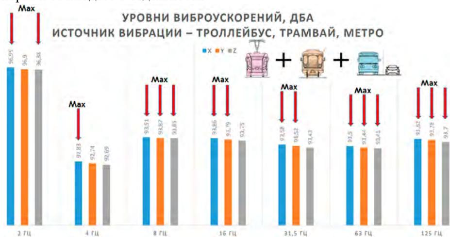
Рис. 5. Графическое отображение уровней виброускорений в октавных полосах от 2 до 125 Гц по улице Краснопрудная от одновременно трех источников. Источник: автор исследования
