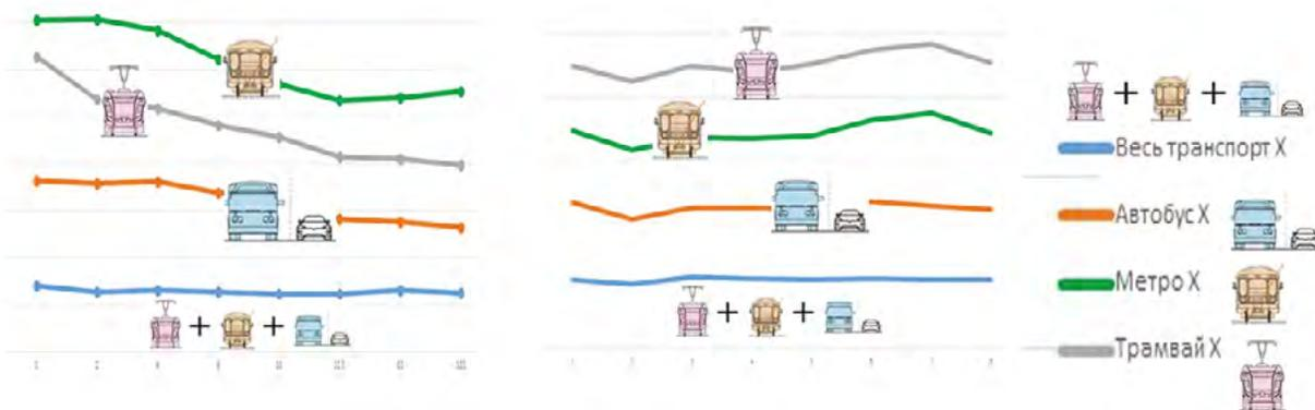
Сводный по оси X график вибрационных воздействий по октавным частотам в подвале здания
