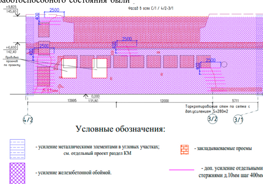
Рис. 3. Фрагмент усиления кирпичной кладки фасада в осях С/1 / 4/2–3/1. Источник: составлено авторами на основе проектной документации
