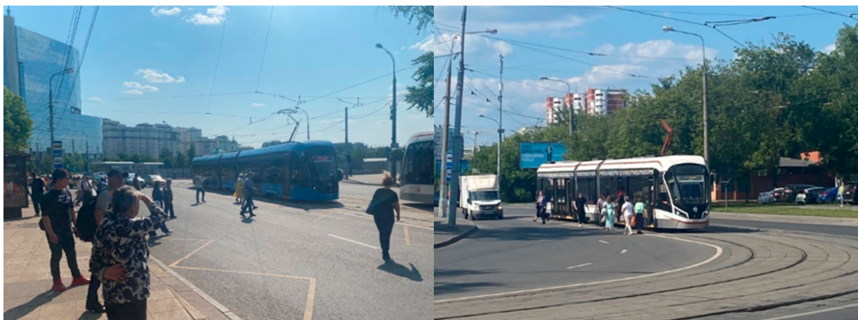
Рис. 1. Высадка пассажиров на проезжую часть при отсутствии приподнятых платформ. Источник: авторы исследования
